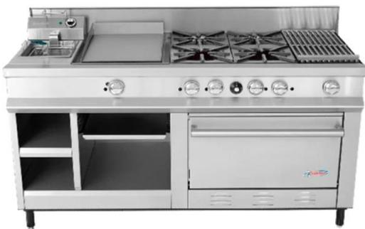
Quemadores de fierro fundido con sistema de concentración de calor al centro del recipiente, con piloto individual. Freidor eléctrico de alta eficiencia producción 12 kg/hr (Conexión eléctrica 125 V (60 Hz) Potencia 3000 W). Quemadores de superficie de fierro fundido
